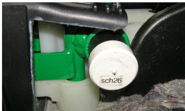
Разметить, используя разметочный шаблон, отверстие в ковровине под корпус замка
