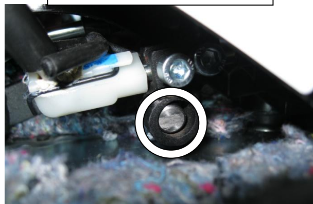
Перевести рычаг переключения передач в положение «R», произвести блокировку, отрегулировать положение хомута на тяге, зафиксировать хомут 2 винтами
