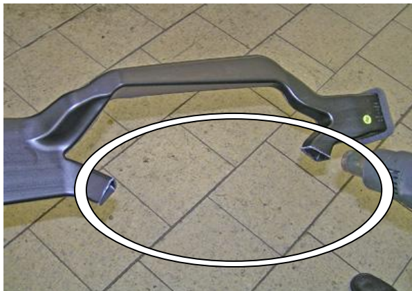
Нагреть феном и сплющить концы воздуховода
