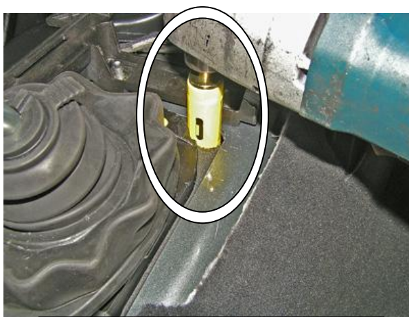
Расширить отверстие до 22 мм.
