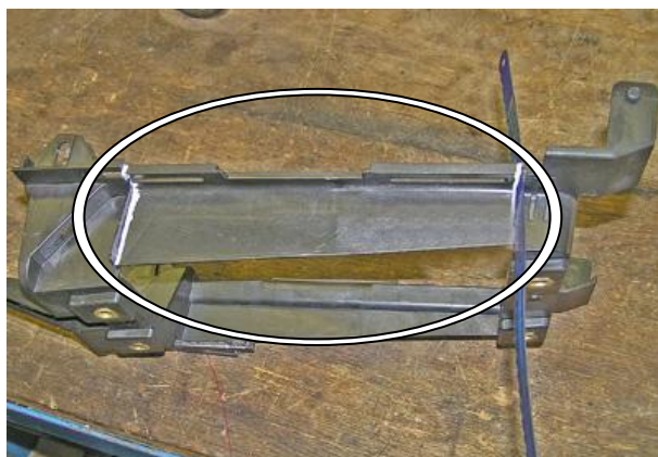
Удалить мешающий пластик держателя консоли
