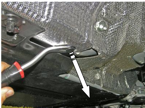
Вынуть клипсу кожуха под днищем
