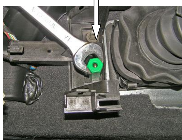
Установить шестигранный столбик на шпильку
