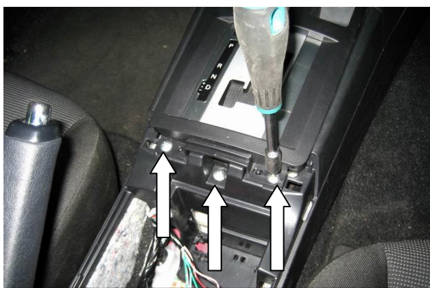
Открутите три винта крепления консоли
