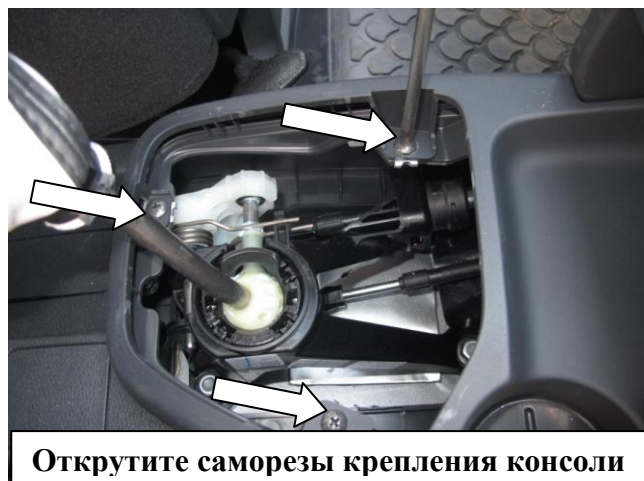
Снимите накладку консоли
