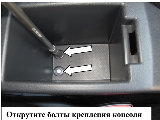
Открутите саморезы крепления консоли с обеих сторон
