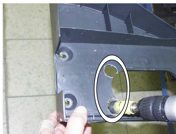
Просверлить отверстия в консоли
