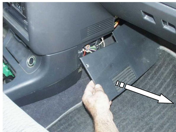
Снять боковые крышки с обеих сторон
