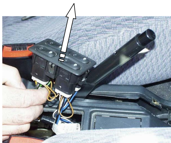
Снять блок, разъединить разъёмы
