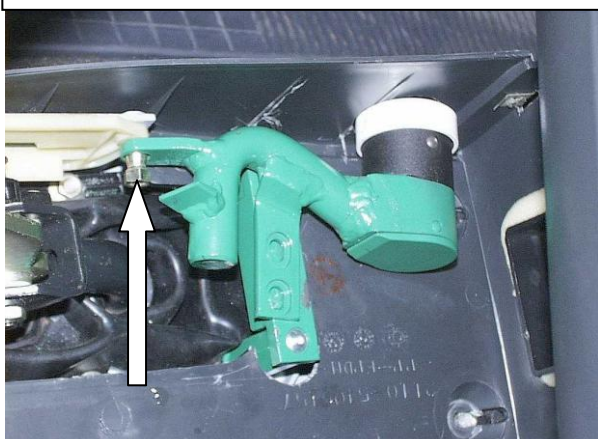
Установить замок на кронштейн, закрутить срывную гайку (не срывать!!!), разметить отверстие в консоли под корпус замка, используя разметочный шаблон
