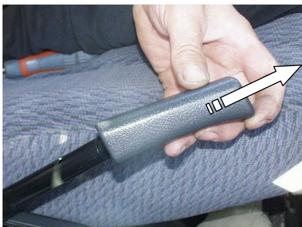
Снять рукоятку стояночного тормоза
