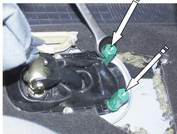
Установить шестигранные столбики на шпильки
