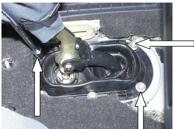
Открутить штатные гайки селектора
