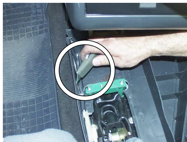
Удалить мешающий установке замка пластик
