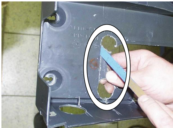
Удалить мешающий пластик консоли
