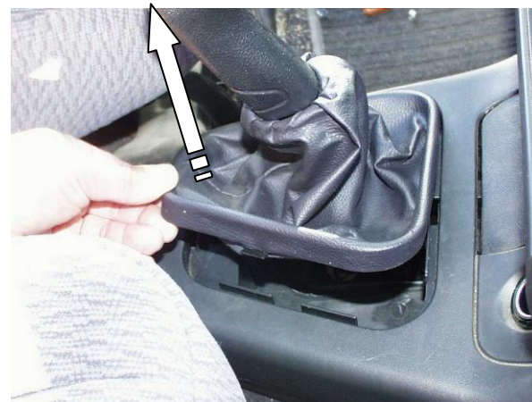
Снять декоративный кожух рычага переключения передач
