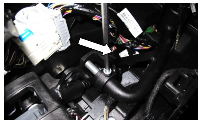
Установите защиту (поз. 3), закрепив болтом (поз. 7)
