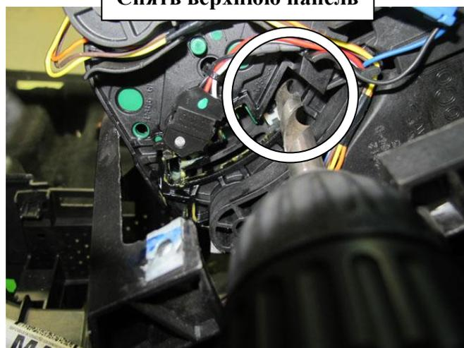
Просверлить отверстие 12 мм.
