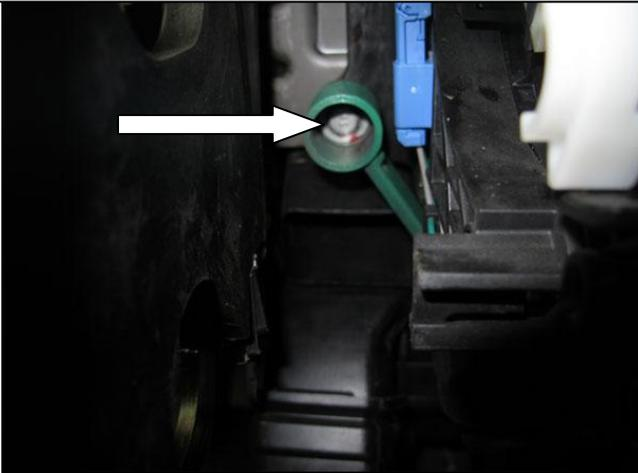
15 Закрутить срывной болт в «стакане» детали-переходника
