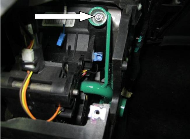
13 Закрутить срывную гайку в «стакане» замка
