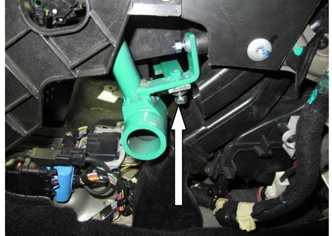
14 Установить деталь-переходник, зафиксировать срывным болтом на замке
