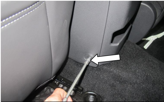
Открутите по одному винту крепления консоли с обеих сторон
