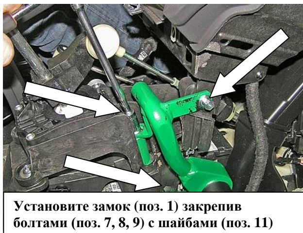
Открутите три болта крепления
