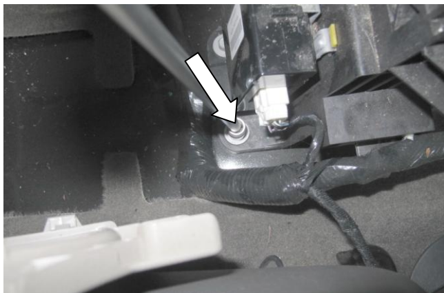
Открутите задний болт крепления селектора
