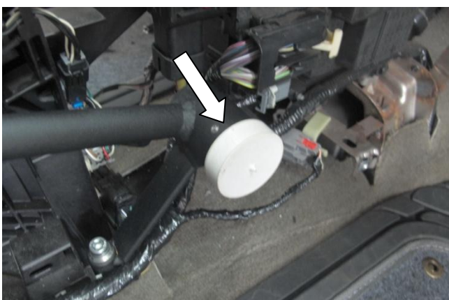
Установите шаблон SCH7 на корпус замка
