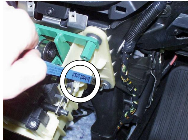
Удалить мешающий установке замка пластик селектора
