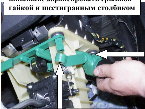
Установить замок на столбик и шпильку, зафиксировать срывной гайкой и болтом
