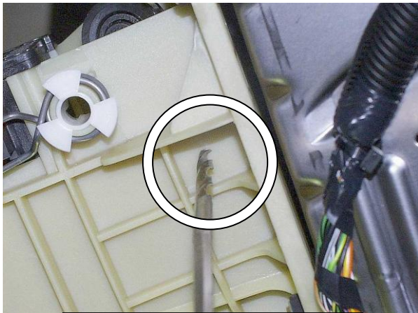
Просверлить отверстие в селекторе под трубу замка
