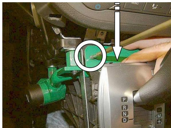
Установить защиту тяг на селектор, просверлить 2 крепёжных отверстия сквозь отверстия в пластине защиты
