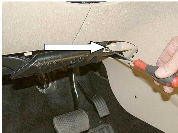
Открутить саморез, снять переднюю консоль
