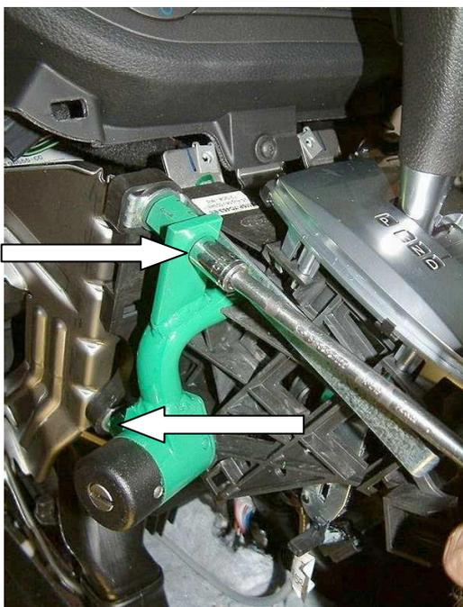
Установить замок на столбики, зафиксировать 2 болтами
