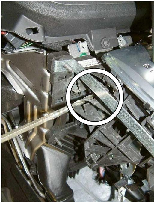
Просверлить отверстие в селекторе под трубу замка
