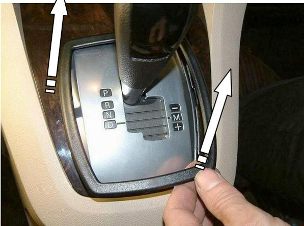
Снять декоративную планку и крышку
