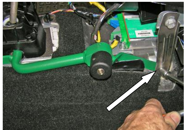
Установить замок, зафиксировать лапку срывной гайкой
