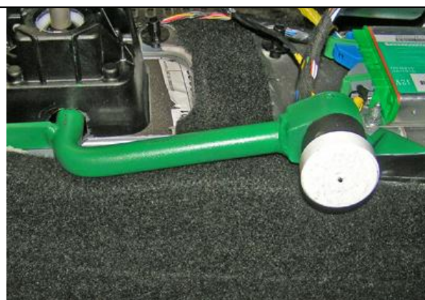
Разметить, используя разметочный шаблон, отверстие в консоли под корпус замка
