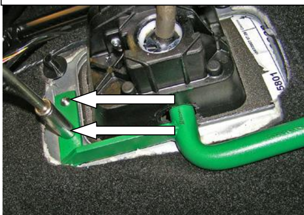
Повторно установить замок, зафиксировать лапку 2 срывными болтами
