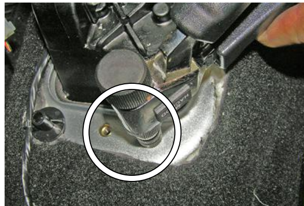
Снять замок, расширить крепёжные отверстия до 9 мм., установить в отверстия резьбовые заклёпки с помощью клёпальника
