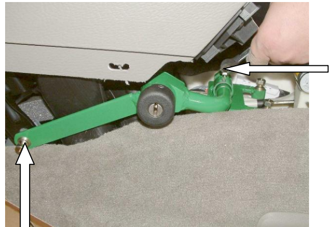
Закрутить срывной болт, зафиксировать трубу заика в кольце кронштейна 2 винтами
