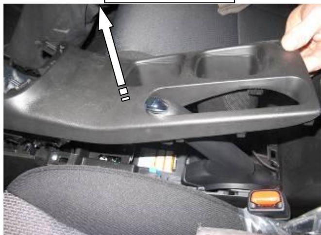
Снять верхнюю крышку
