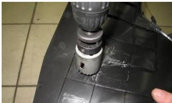
**Просверлить и расширить отверстие до 32 мм.**
