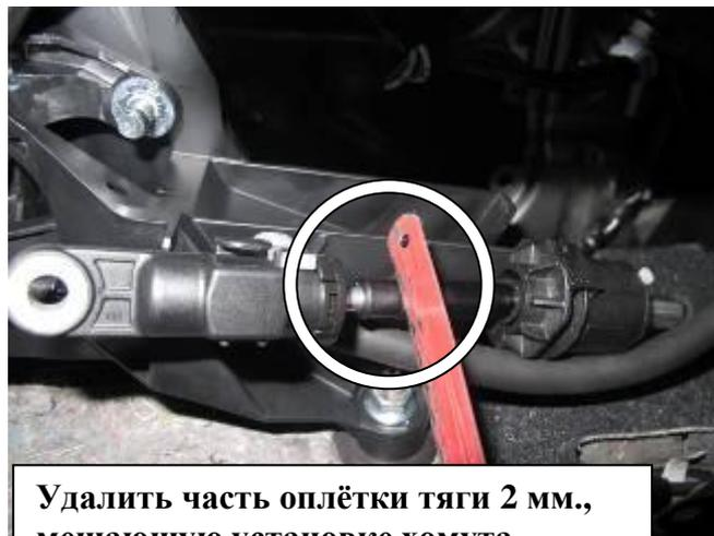
Удалить часть оплётки тяги 2 мм., мешающую установке хомута
