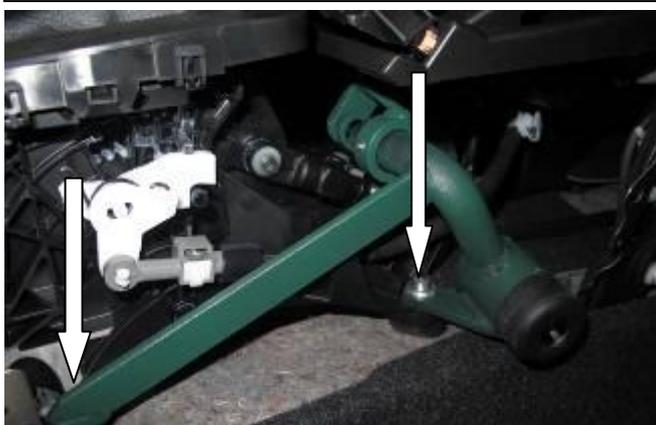
Открутить 2 штатные гайки селектора, установить замок на шпильки, закрутить 2 срывных гайки (не срывать!!!)
