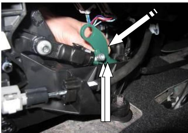
Установить хомут на тягу, зафиксировать винтом (крепеж не срывать!!!)
