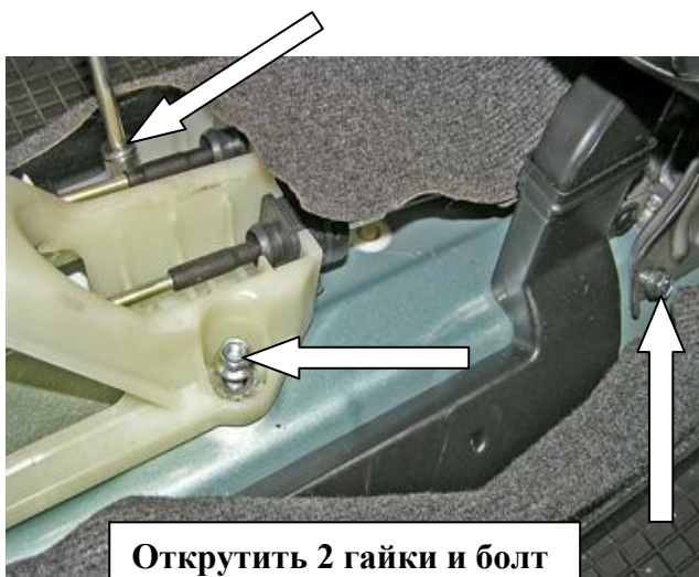
Удалить мешающее ребро жёсткости консоли
