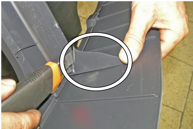
Удалить мешающее ребро жёсткости консоли
