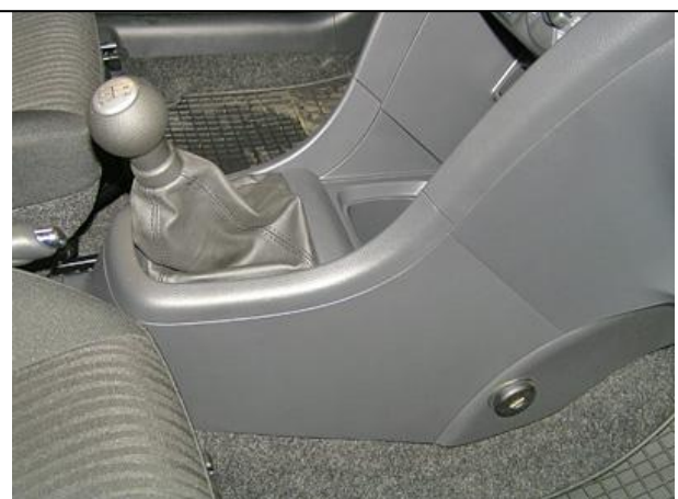
Разметить, используя разметочный шаблон, и просверлить отверстие в боковой крышке под корпус замка, собрать консоль
