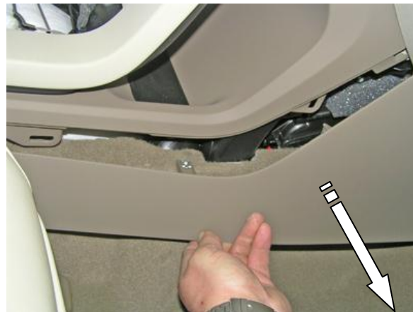
Снять боковые крышки с обеих сторон
