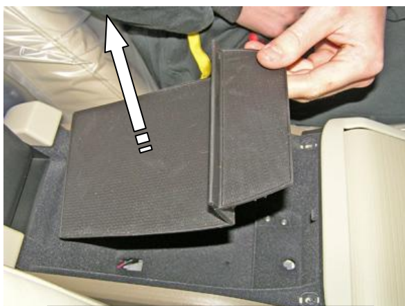
Поднять подлокотник, снять декоративную прокладку
