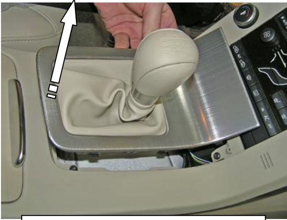
Снять декоративную крышку рычага переключения передач
