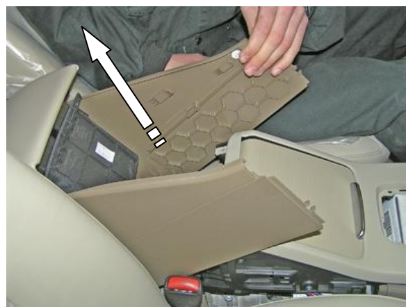
Снять заднюю консоль
