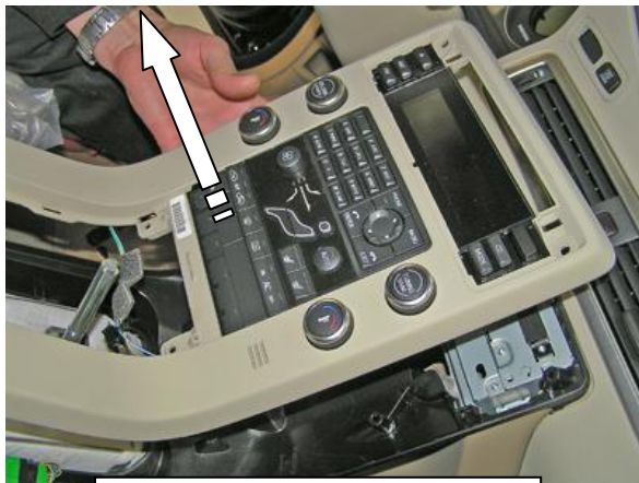
Снять переднюю панель
