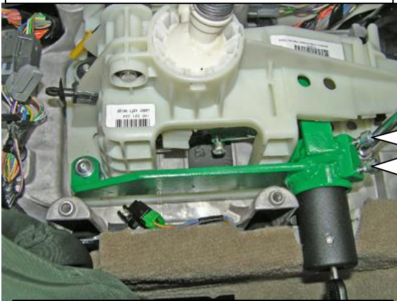
Отрегулировать выход прямоходного цилиндра из кронштейна замка, сорвать винты
