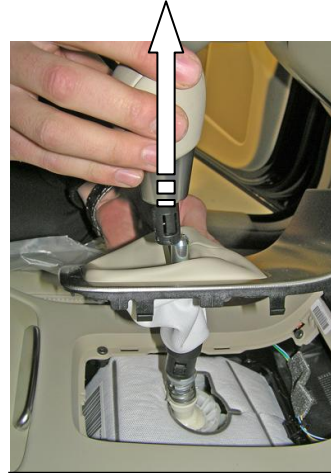
Снять рукоятку рычага переключения передач
