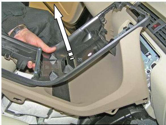
Снять заднюю консоль
