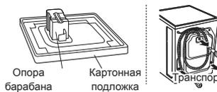
Снимите транспортировочные болты и опоры.
