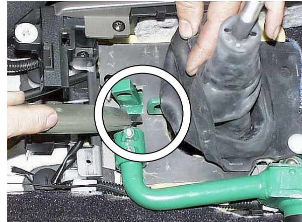
Вырезать часть звукоизоляционного коврика селектора, мешающую работе замка
