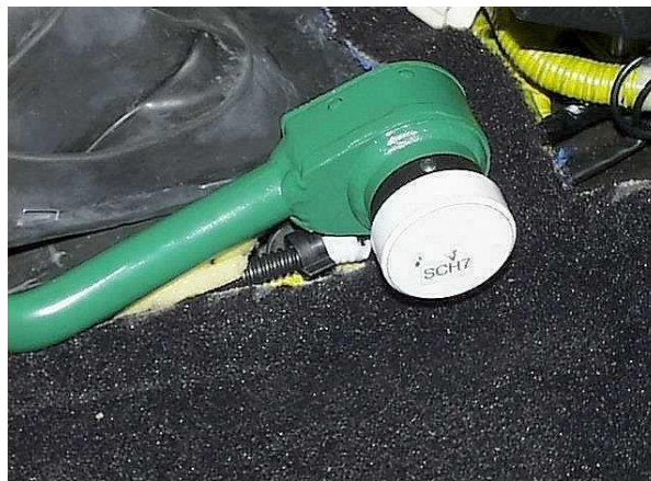
19 Разметить, используя разметочный шаблон, отверстие в консоли под корпус замка
