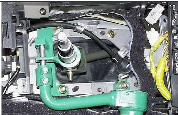
Перевести рычаг переключения передат в положение «R», произвести блокировку, отрегулировать положение хомута на рычаге
