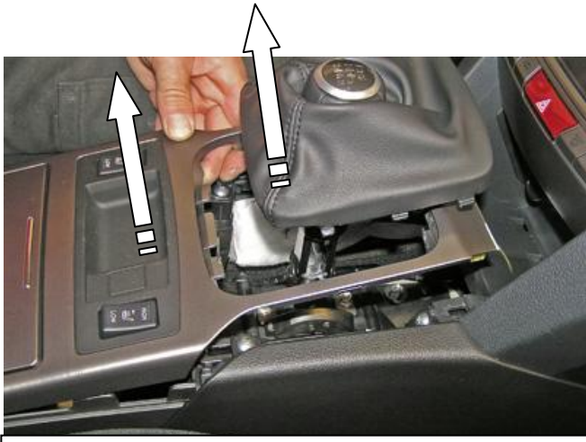
Снять декоративный кожух и верхнюю панель
