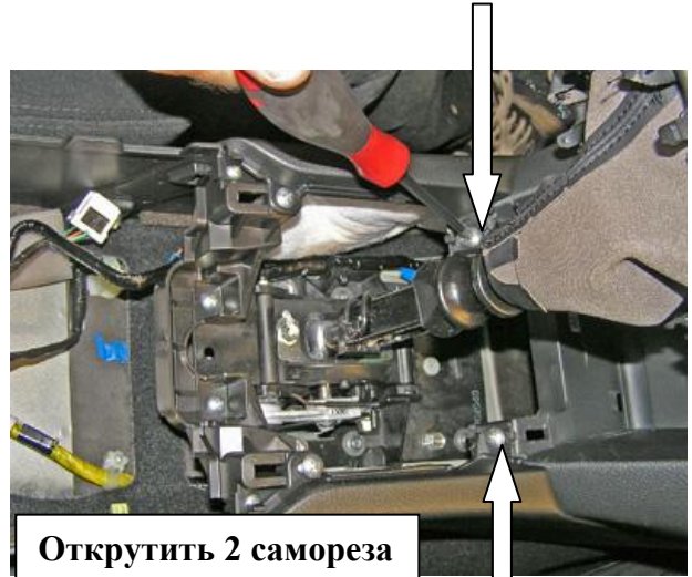
Снять декоративный кожух и верхнюю панель
