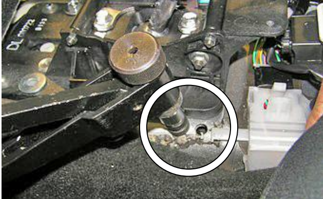
Установить заклёпочные гайки в отверстия
