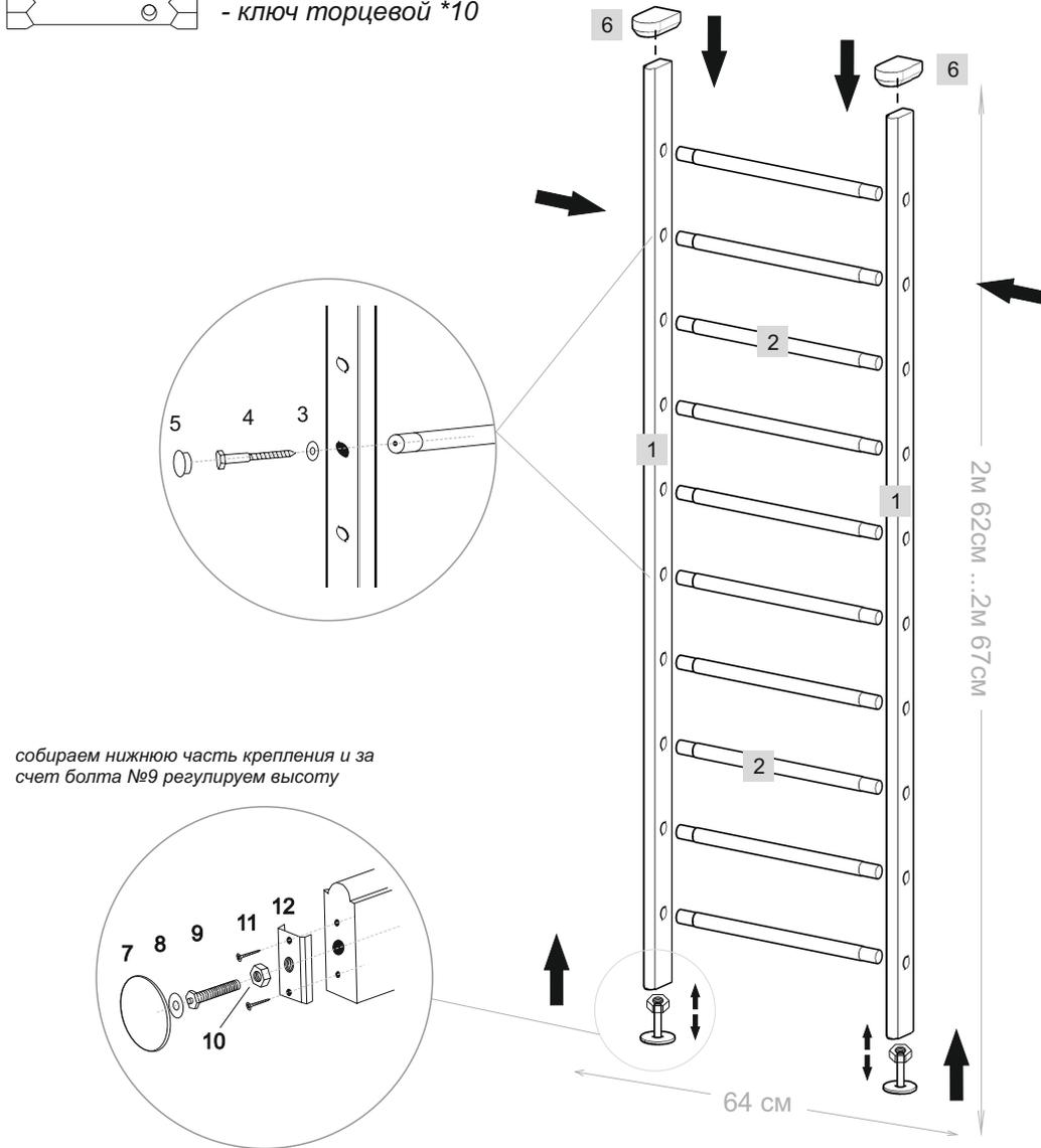
собираем нижнюю часть крепления и за счет болта №9 регулируем высоту
