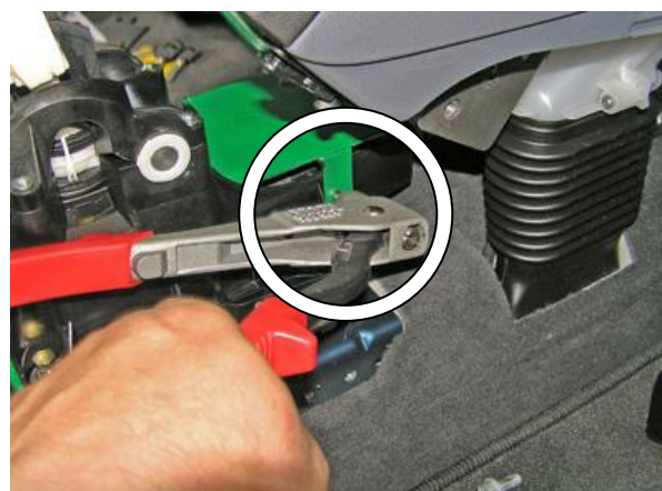
Зафиксировать защиту тяг на селекторе через крепёжные отверстия с помощью заклёпок и клёпальника
