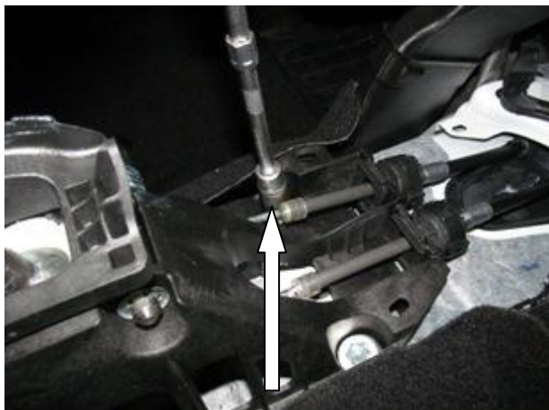
Открутить штатный болт селектора
