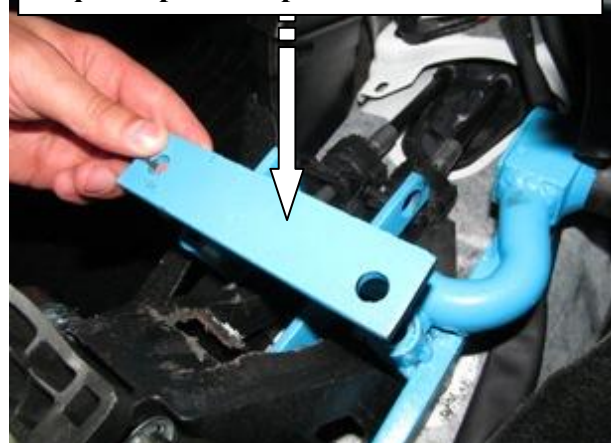
Установить защиту ригеля на столбик и замок
