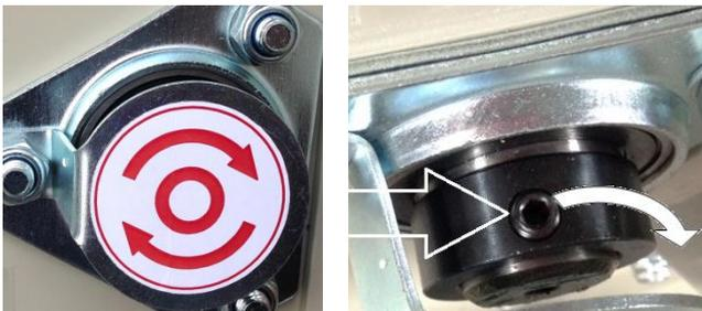
Beobachten Sie bei einem **leeren Fülltrichter** die Drehrichtung des Kugellagers.
