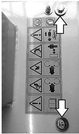
Für Arbeiten am Sieb oder an den Messern kann der Fülltrichter geöffnet werden. Der passende Schraubenschlüssel liegt der Betriebsanleitung bei.
