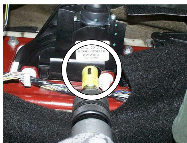
Просверлить отверстие в селекторе под трубу замка
