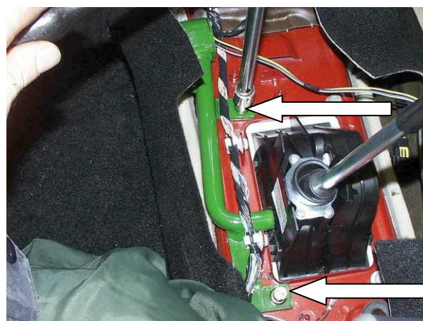
Установить замок, закрутить 2 болта
