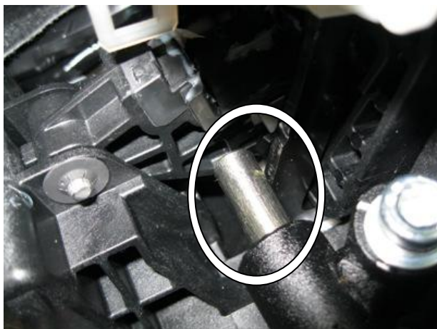
Перевести рычаг переключения передач в положение «Р», произвести и проверить блокировку, сорвать болты
