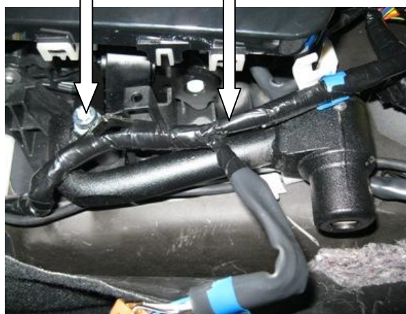
Установить замок на пластину-переходник, закрутить 2 срывных болта
