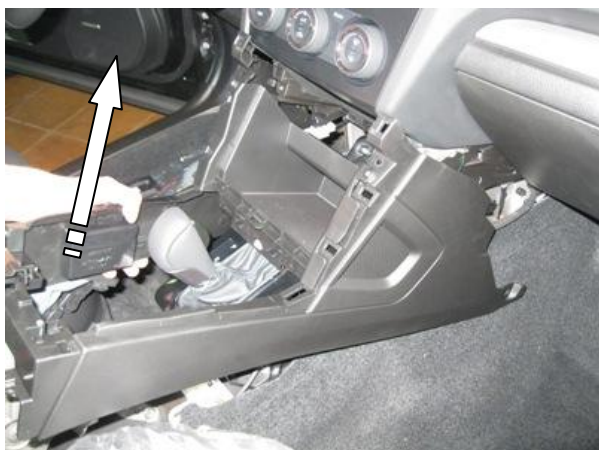
Снять переднюю консоль
