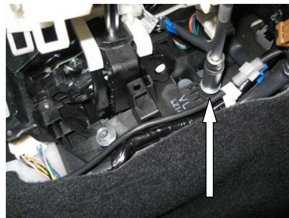
Открутить штатный болт селектора
