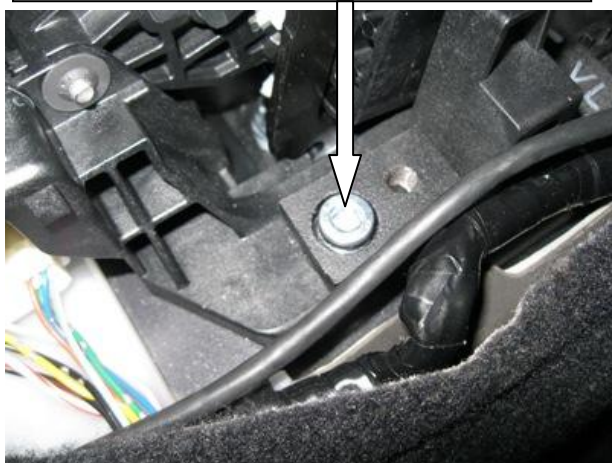
Закрутить срывной болт
