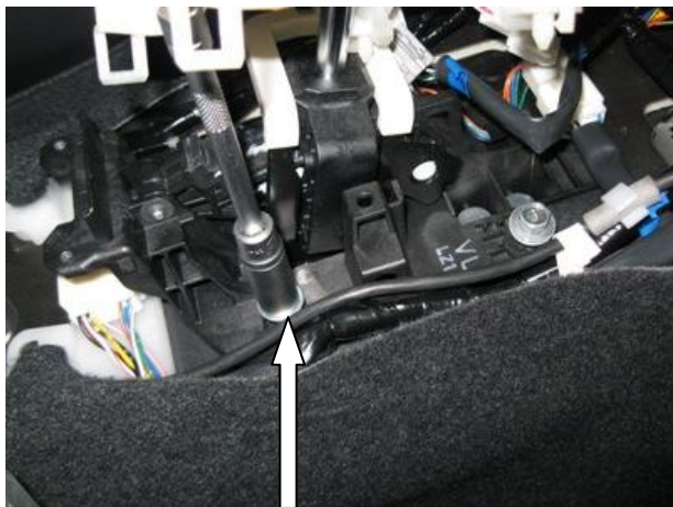
Открутить штатный болт селектора
