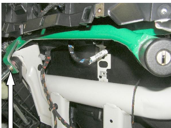
Установить замок, закрутить срывной болт
