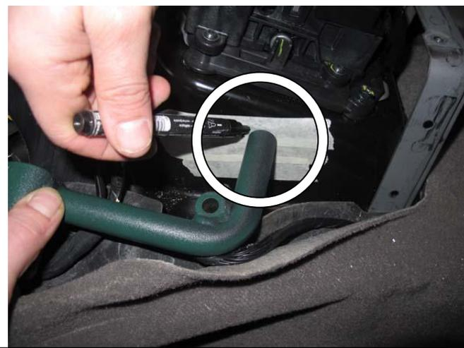
Установить замок столбиком на шестигранный столбик, разметить точку сверления селектора по трубе замка
