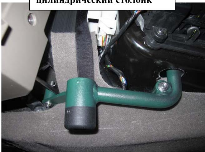
23 Перевести рычаг переключения передач в положение «Р», произвести и проверить блокировку, сорвать болты
