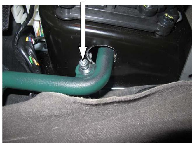
20 Повторно установить замок столбиком на шестигранный столбик трубой в отверстие, закрутить срывной болт (не срывать!!!)
