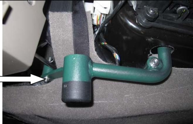
22 Зафиксировать лапку замка срывным болтом (не срывать!!!)
