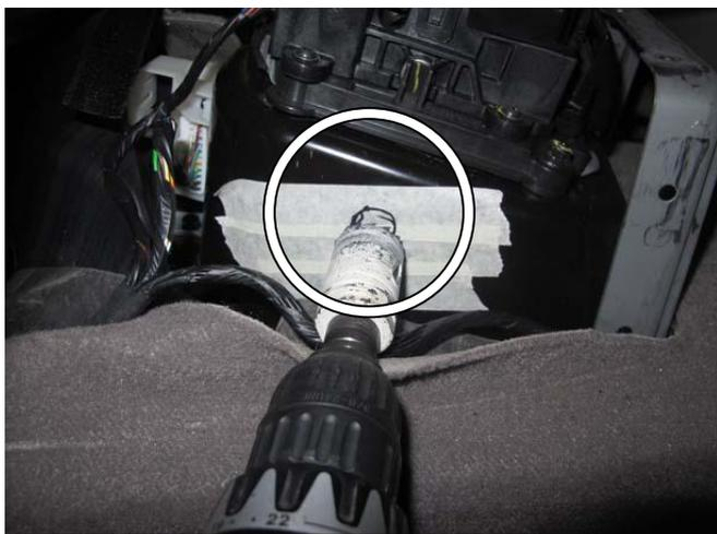
19 Снять замок, просверлить в селекторе отверстие 22 мм. под трубу замка
