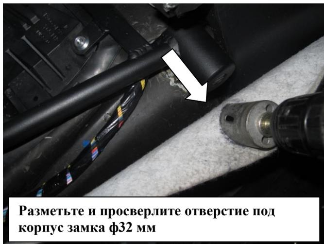
Разметьте и просверлите отверстие под
