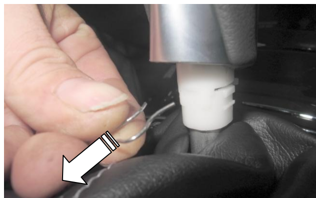
Отсоедините кожу рычага переключения передач КПП и снимите фиксатор
