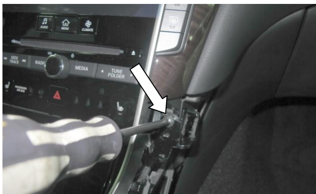
Открутите два винта крепления консоли с обеих сторон
