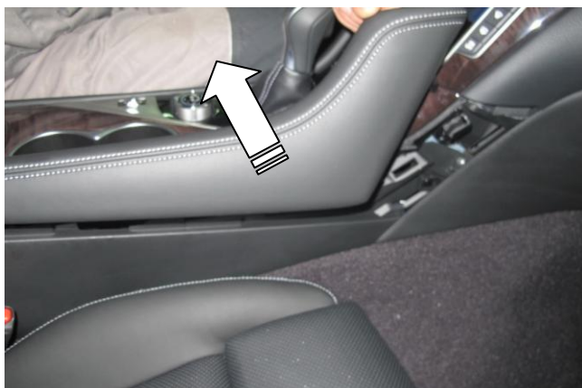
Снимите накладку консоли с обеих сторон
