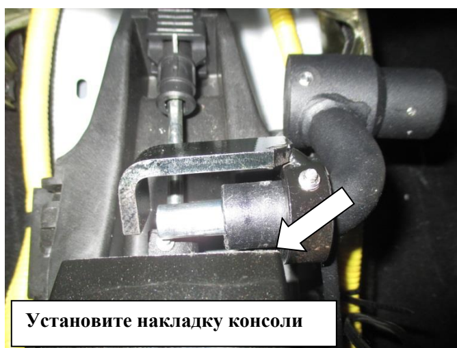
Удалите часть пластика накладки консоли
