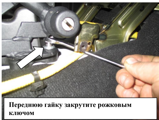
Снимите наконечник тяги тяги КПП, разверните на 180 градусов и установите обратно
