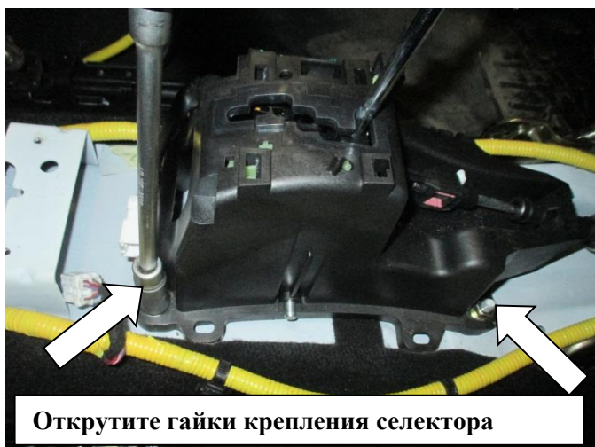
Снимите наконечник тяги тяги КПП, разверните на 180 градусов и установите обратно
