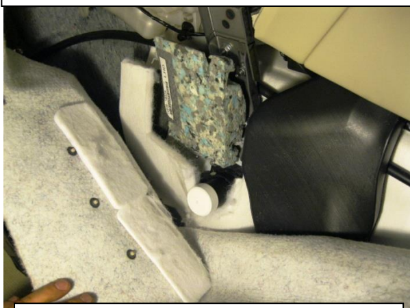
Разметить, используя разметочный шаблон, отверстие в ковровине под цилиндр замка
