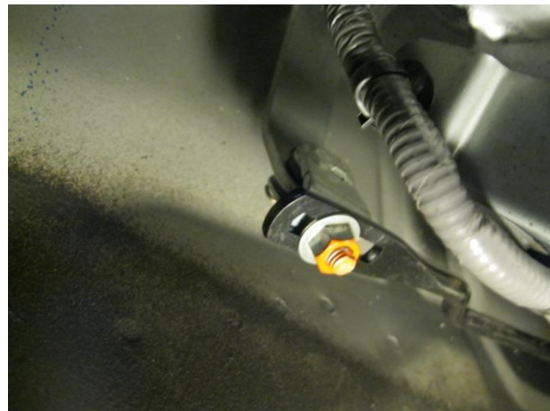
Установить дополнительную защиту тяги 14
