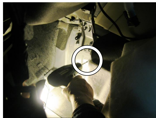
Просверлить отверстие в днище под прямоходный цилиндр замка
