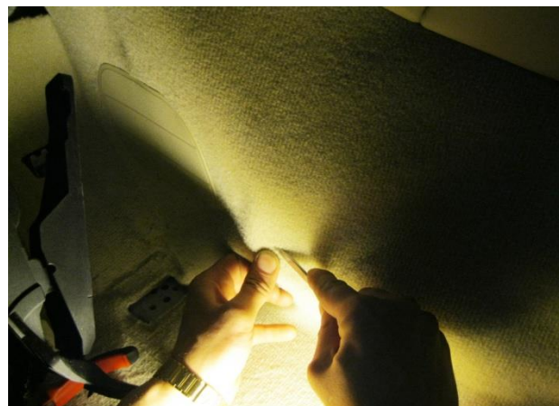
Вырезать отверстие в ковровине под цилиндр замка
