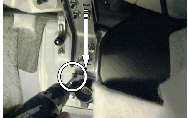
Установить на отверстие кронштейн замка, просверлить 4 крепёжных отверстия в днище сквозь отверстия в кронштейне
