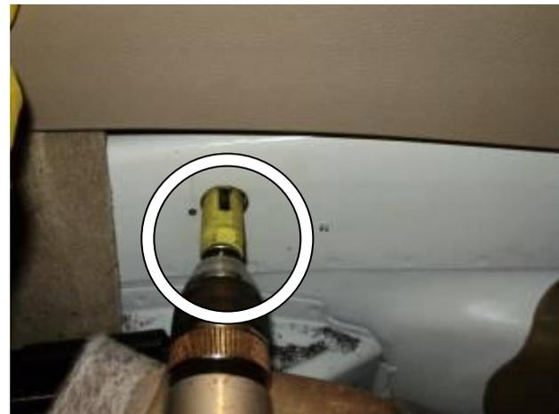
Просверлить по шаблону отверстие 22 мм. в днище под трубу замка
