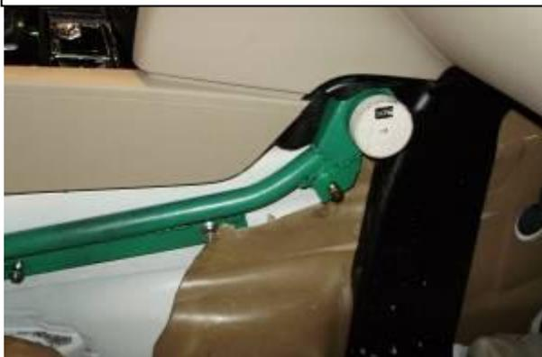
15 **Разметить, используя разметочный шаблон, отверстие в ковровине под корпус замка**
