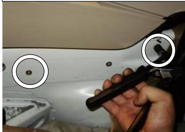
Установить в отверстия 2 заклёпочные гайки, используя клёпальник
