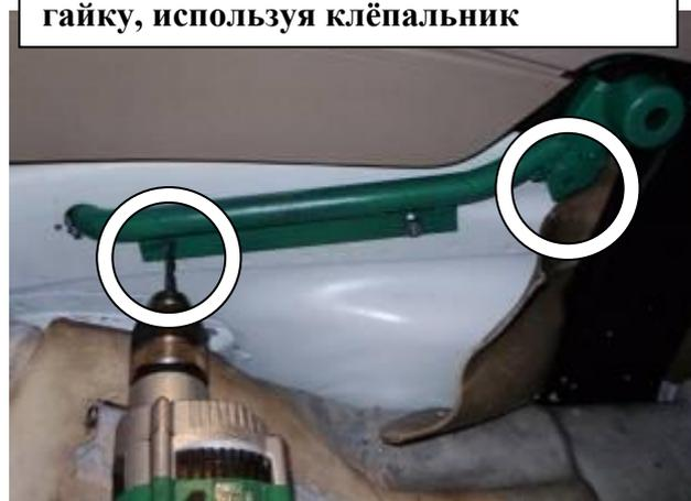
После проверки блокировки разметить в днище 2 крепёжных отверстия сквозь отверстия в пластине замка
