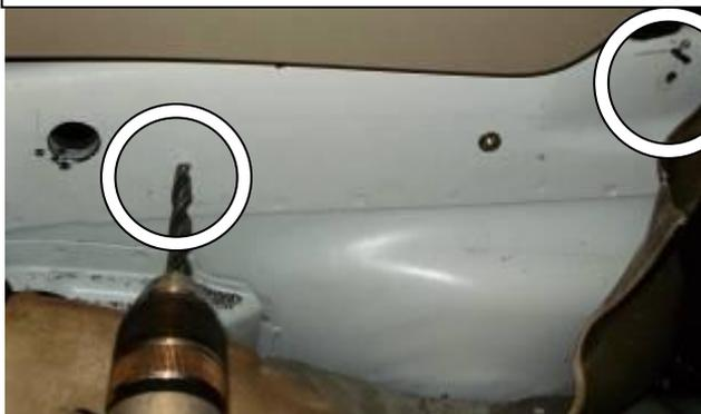
Снять замок, просверлить 2 крепёжных отверстия 9 мм. по разметке
