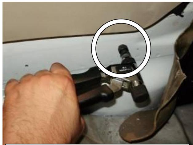
Установить в отверстие заклёпочную гайку, используя клёпальник
