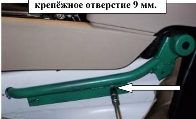
Установить замок трубой в отверстие, зафиксировать срывным болтом 20 мм. (не срывать!!!).
