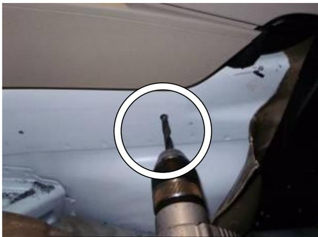
Просверлить в днище крепёжное отверстие 9 мм.
