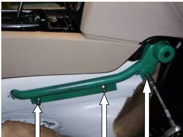
13 **Повторно установить замок, окончательно проверить блокировку, зафиксировать 3 срывными болтами**
