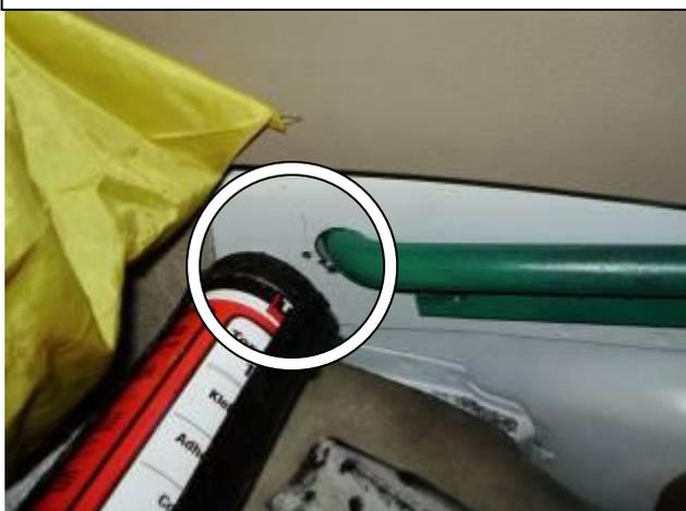
17 **Загерметизировать отверстие в днище герметиком**
