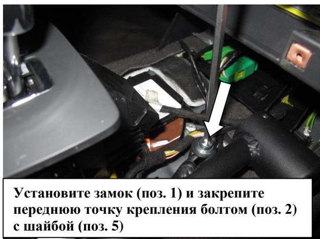
Установите замок (поз. 1) и закрепите переднюю точку крепления болтом (поз. 2) с шайбой (поз. 5)
