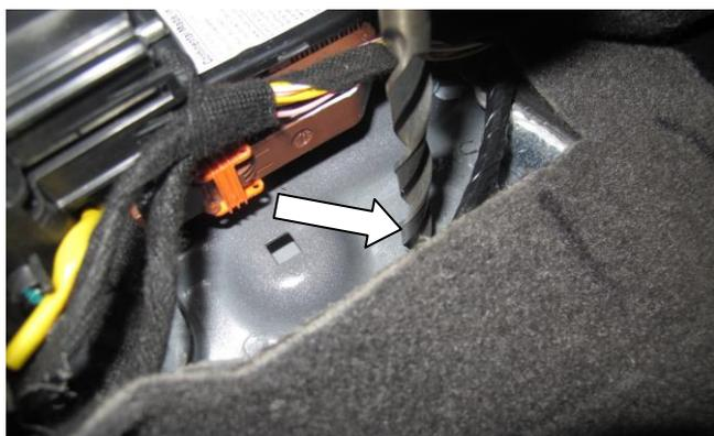
В обозначенном месте просверлите отверстие Ø9 мм
