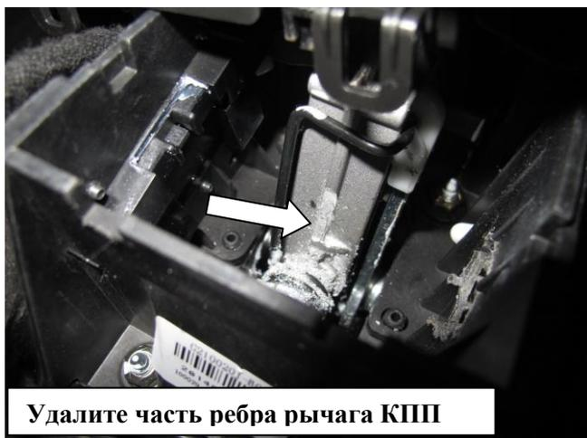
Удалите часть ребра рычага КПП
