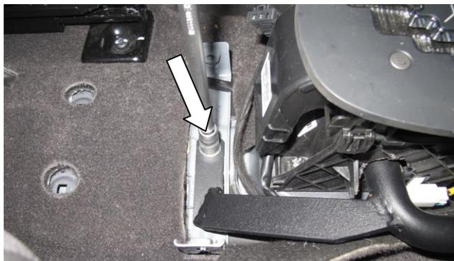
Закрепите заднюю точку крепления замка (поз. 1) гайкой (поз. 3) с шайбой (поз. 5)
