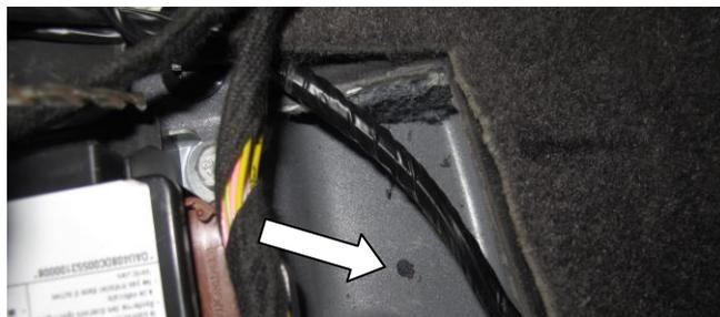
Приложите замок (поз. 1) по задней точке крепления. Закройте замок (поз. 1). При необходимости выполните регулировку замка (поз. 1). Отметьте место переднего крепления замка. Снимите замок (поз.1).
