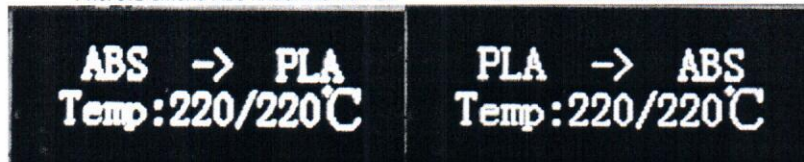
Рис. 9.1 Смена ABS пластика на PLA
