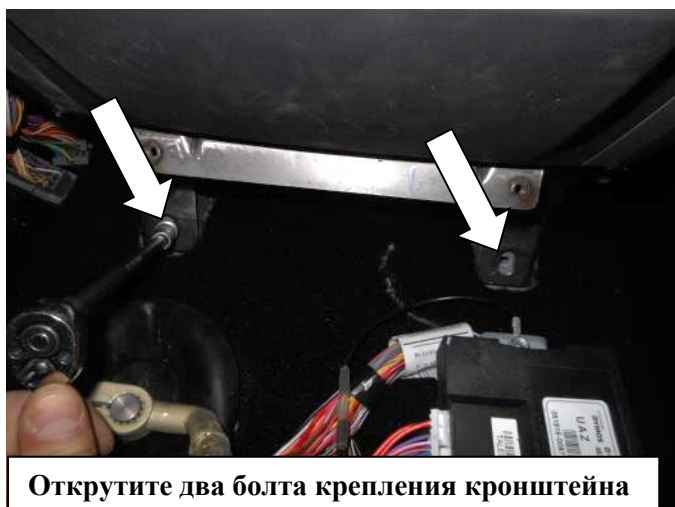
Открутите болт крепления блока
