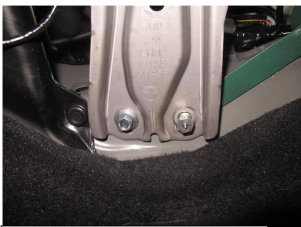
Зафиксируйте переднюю точку крепления срывным винтом
