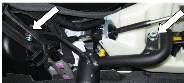
Установите замок (поз. 1), закрепив переднюю точку крепления болтом (поз. 5) и гайкой (поз. 7) с шайбами (поз. 8), а заднюю точку крепления замка болтом (поз. 6) с шайбой (поз. 8)
