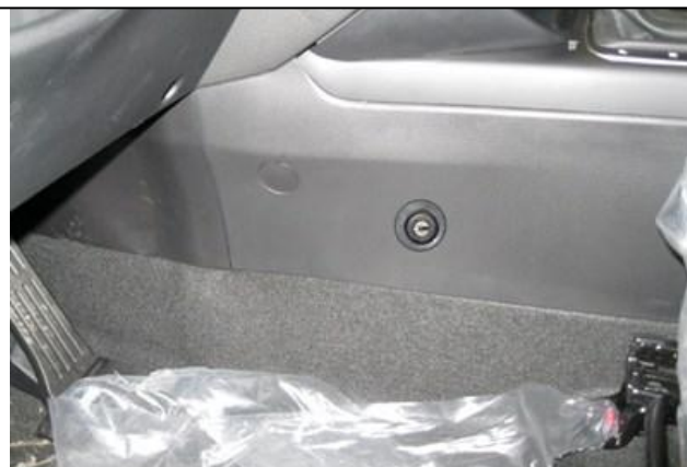
21 Разметить, используя разметочный шаблон, просверлить и расширить отверстие в консоли под корпус замка, установить консоль на место 22
