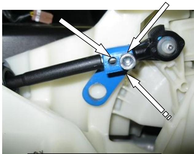
Установить хомут на тягу, зафиксировать 2 винтами
