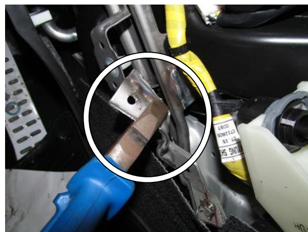
Удалить часть стойки селектора, мешающую установке замка
