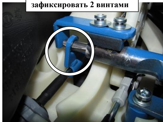
Перевести рычаг переключения передач в положение «R», произвести блокировку, отрегулировать положение хомута на тяге, сорвать 2 винта
