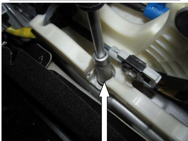
Открутить штатный болт селектора
