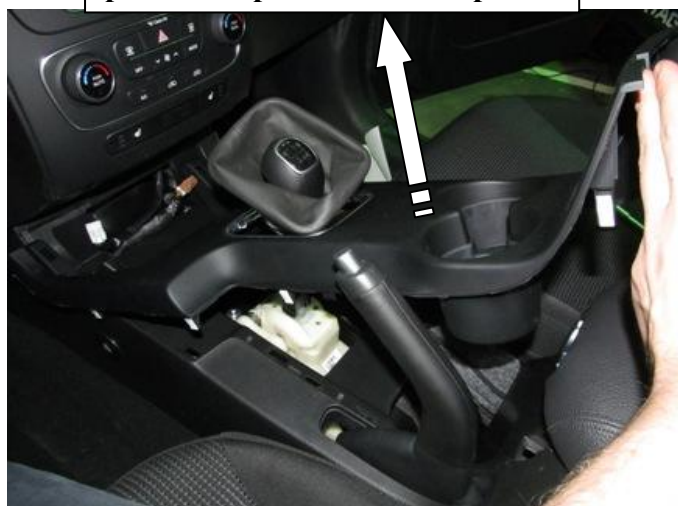
Снять верхнюю крышку
