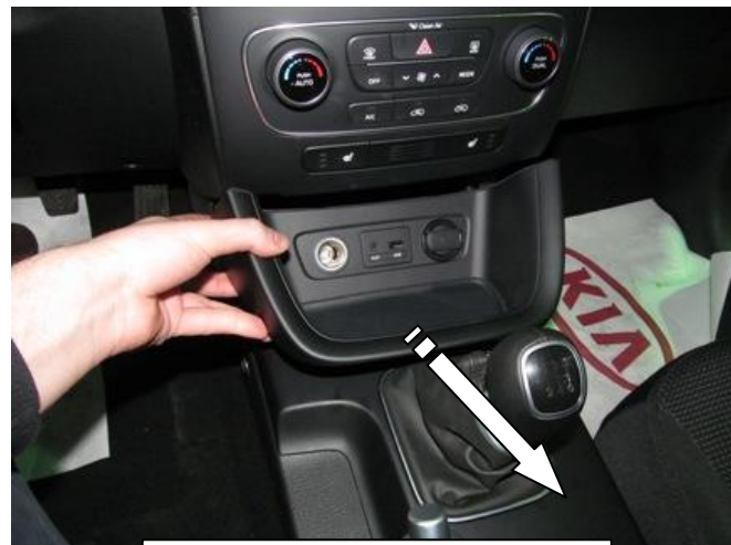
Снять переднюю крышку
