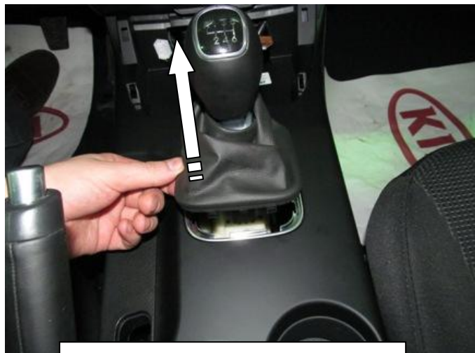
Снять декоративный чехол рычага переключения передач
