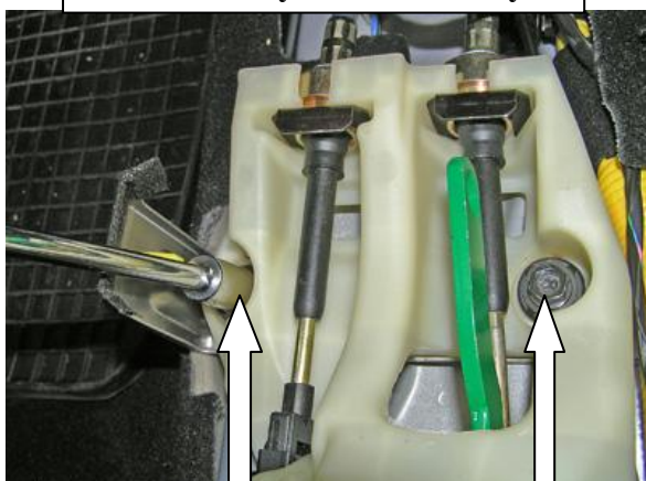
Открутить 2 штатных болта селектора
