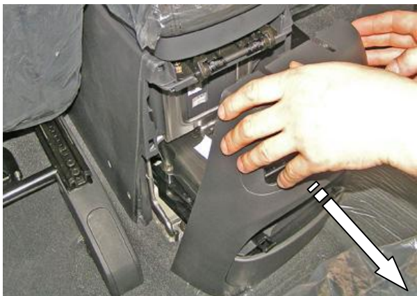
Снять заднюю панель
