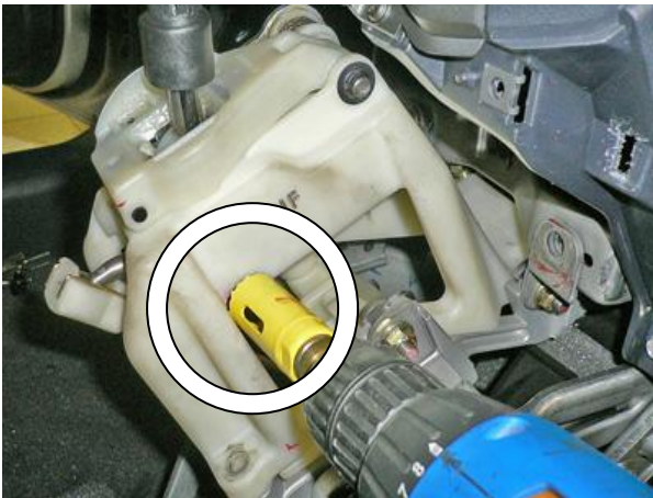
Просверлить отверстие в селекторе под трубу замка
