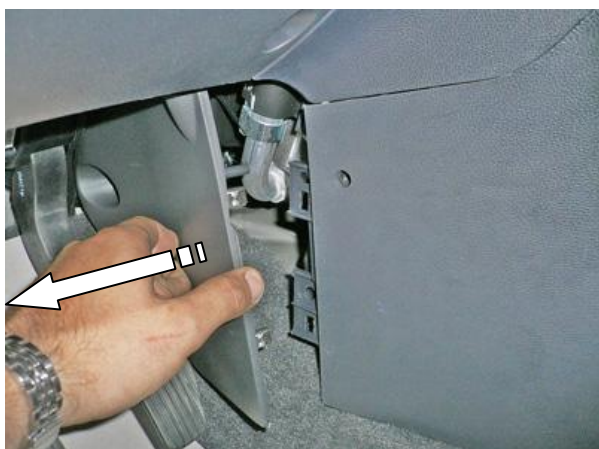
Снять боковые крышки с обеих сторон
