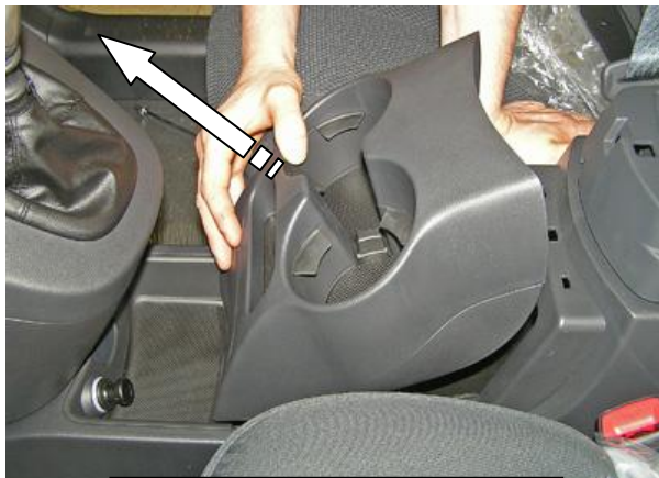
Снять верхнюю крышку
