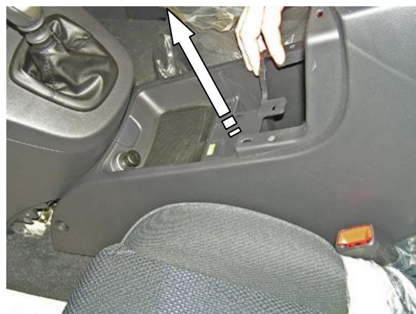
Снять заднюю консоль
