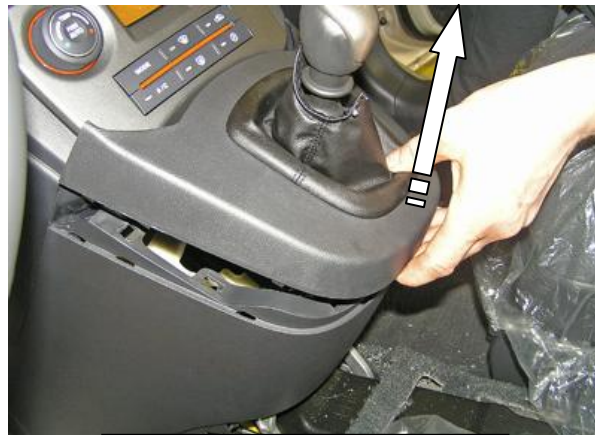
Снять верхнюю крышку
