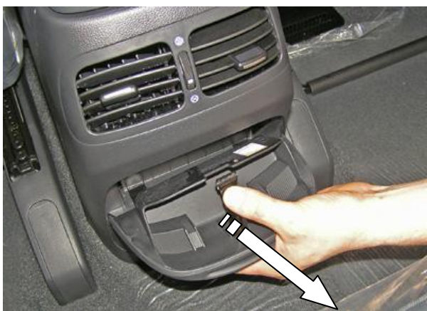
Снять заднюю крышку
