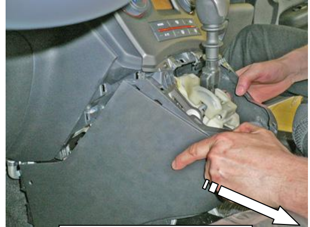
Снять заднюю консоль
