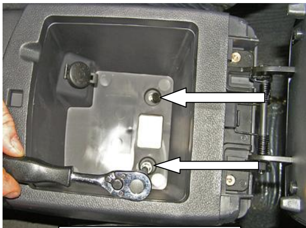
Поднять подлокотник, открутить 2 самореза
