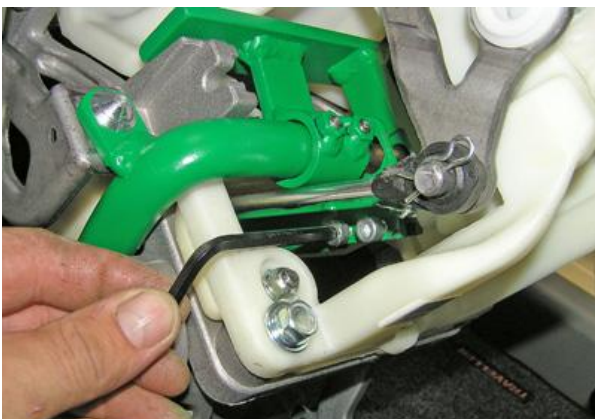
Перевести рычаг переключения передач в положение «R», произвести блокировку, отрегулировать положение хомута на тяге, сорвать винты
