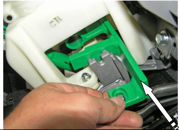
Установить кронштейн замка на селектор
