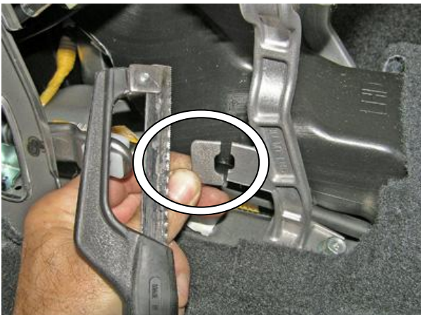
Удалить мешающий металл стойки селектора
