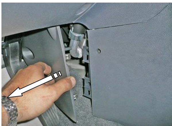
Снять боковые крышки с обеих сторон
