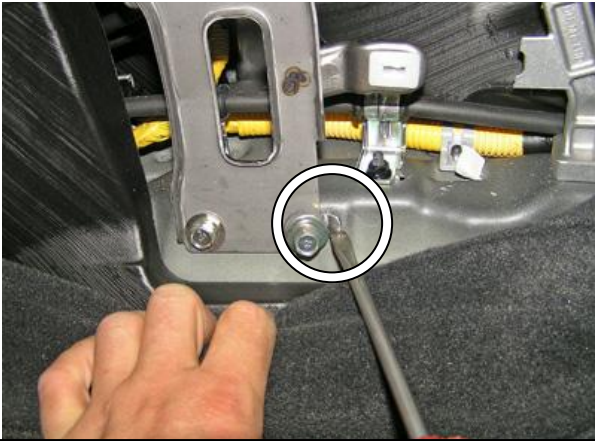
Удалить мешающий металл селектора
