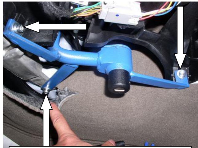
Установить замок, закрутить 3 болта
