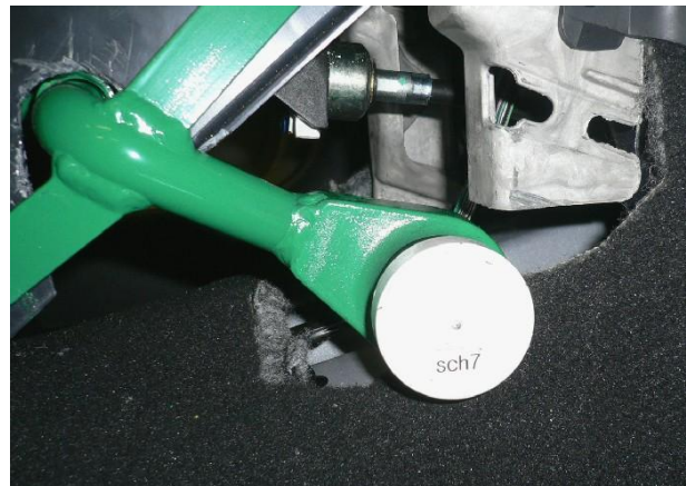
19 Разметить, используя разметочный шаблон, отверстие в консоли под корпус замка
