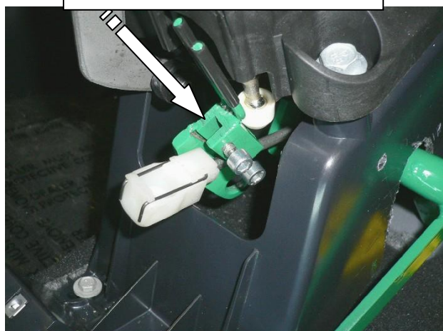
Установить хомут на тягу
