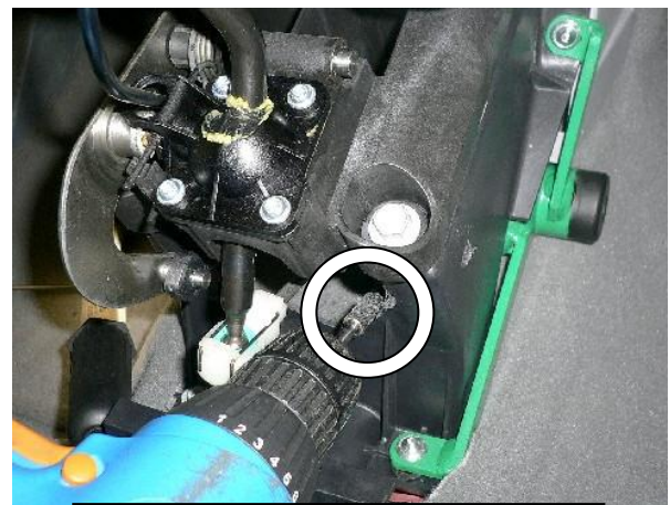
Удалить пластик селектора, мешающий установке хомута
