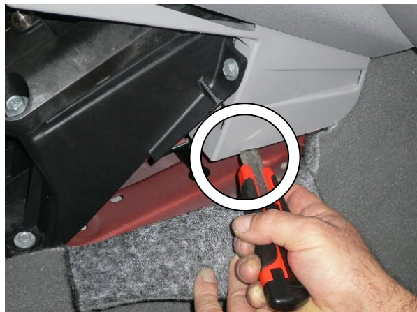
Удалить мешающий установке замка пластик
