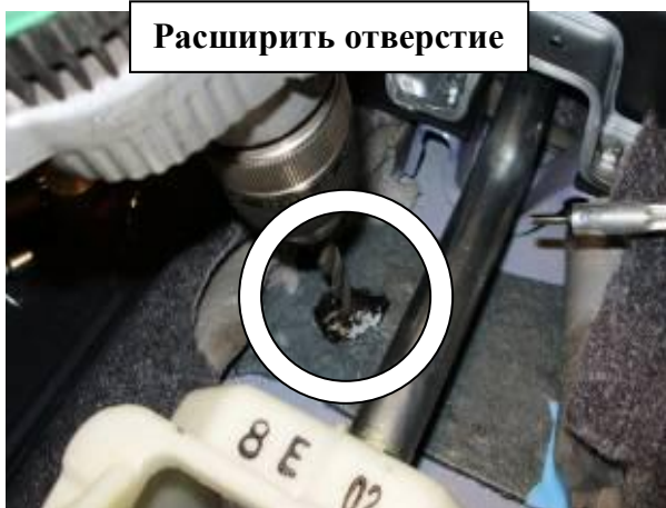
Просверлить в днище отверстие через отверстие в кронштейне, снять кронштейн
