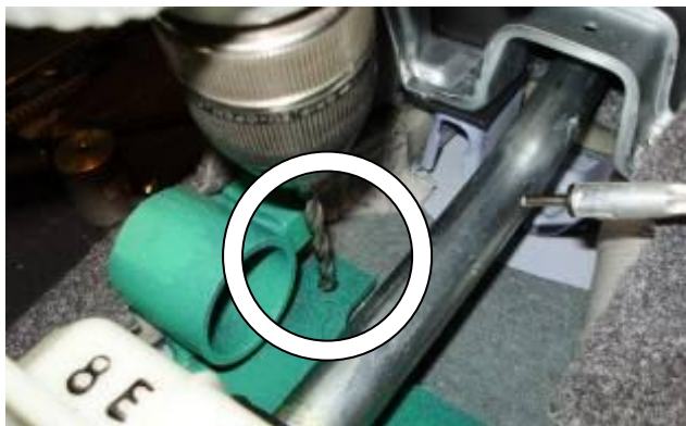
Просверлить в днище отверстие через отверстие в кронштейне, снять кронштейн
