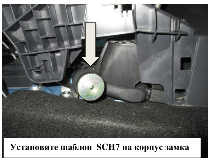
Разметьте и просверлите отверстие под корпус замка ф 32мм
